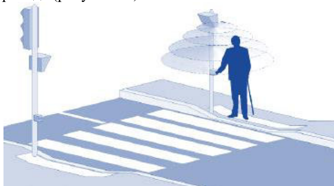
Рисунок 13 – Примеры размещения направленности действия технических средств звуковой сигнализации на регулируемых пешеходных переходах
