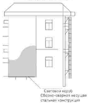
Схема расположения поддерживающих конструкций светоскоба
