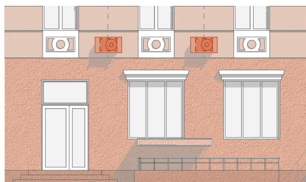
При наличии архитектурных элементов под окном кондиционер за экраном необходимо размещать в простенке.
