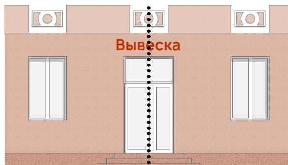
Вывеска, а также знаки на ней должны размещаться симметрично относительно вертикальной оси, в качестве которой выступает центральная ось проема (оси, окна, витрины) или простенка. Информация на вывеске может размещаться не более чем в 2 строки.\*
